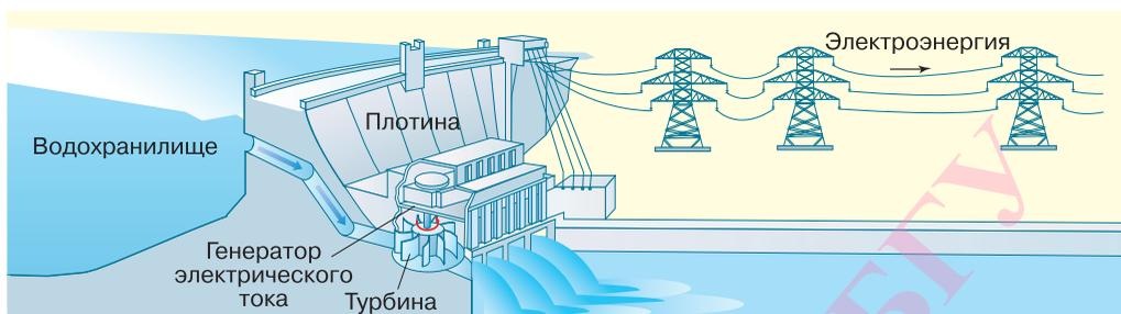
Рис. 110. Схема работы ГЭС
